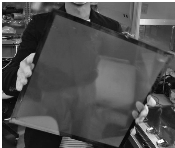
図5 300 mm 角基板を用いた G-GEM の試作
