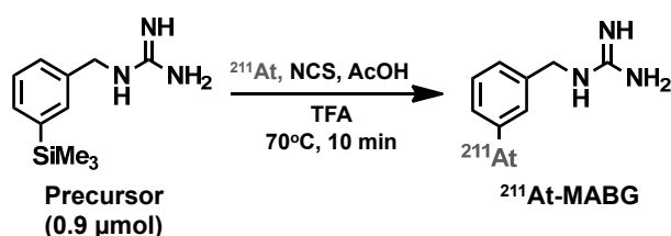
図 2 ^{211}\text{At} -MABG 合成反応 (文献 10) より抜粋)
