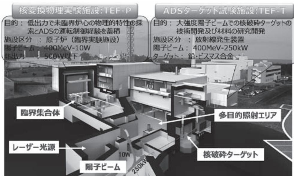
図4 J-PARC 核変換実験施設概念図
