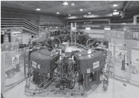
写真2 シンクロトロン本体
