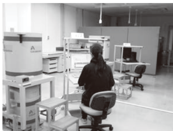
写真3 放射能分析室 円筒型で横のラインの入っている装置がゲルマニウム半導体検出器である
