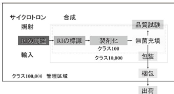
図1 放射性医薬品の製造工程・概要
