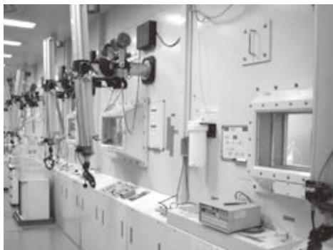
写真2 ホットセル サイクロトロンで製造された放射性物質を 分離精製する
