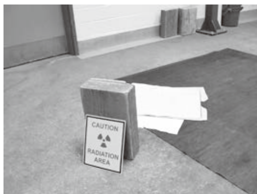
図 4 検査室内で尿をしてしまった場合、速やかに拭き取り、放射線が検出されなくなるまで警告を示して周囲に知らせる
