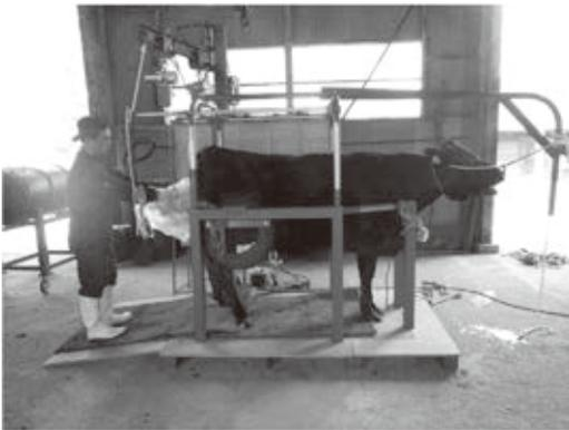
図2 導入した生体測定装置
