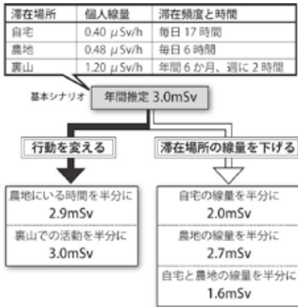
図 6 外部被ばく推定支援ツール（暫定版）を使用し個人線の被ばく線量をシナリオ別に解析した例
