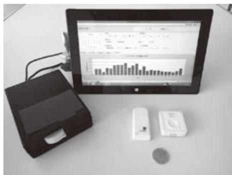
図1 調査に使用した個人線量計（D-シャトル）と管理機（手前左）とパソコン上に読み出した1時間ごとの線量（上）とGPSロガー（手前右）
