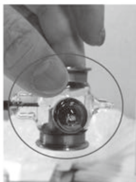
図 5 焦電結晶熱励起方式の小型 X 線源
