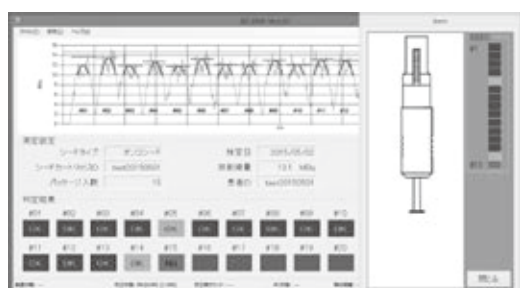
図3 制御パソコン画面上に表示される各シードの放射線強度プロファイル及び特殊なアルゴリズム解析 5) による放射線強度判定結果
