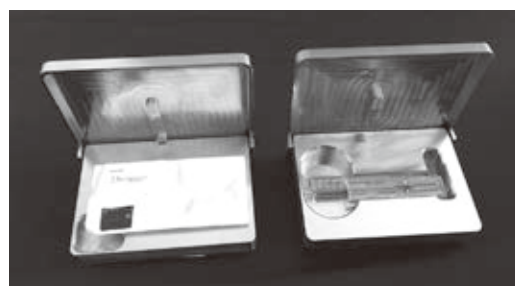
図5 シードカートリッジを保持するリムーバルテンプレート 左がオシコシード用、右がブラキソース用のカートリッジを置いたときの様子
