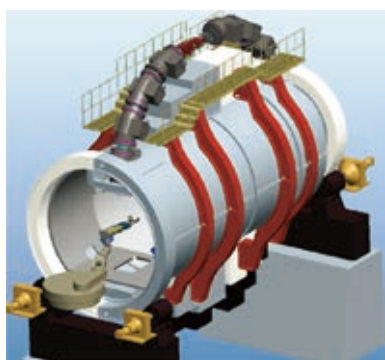
図1 重粒子線治療用超電導小型回転ガントリー (約13m×5.5m)
