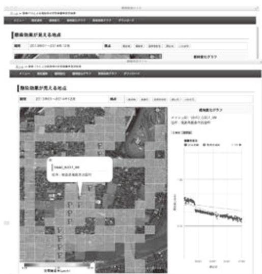
図5 JAEAのサイトで公開されているKURAMA-IIで除染効果の捉えた地点の紹介 除染による空間線量率低減とその効果が維持されている様子が経時変化にはっきり現れている
