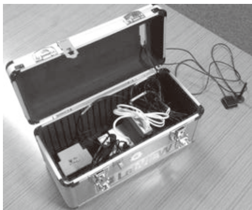
図1 KURAMA-II車載機 全体が34.5 cm×17.5 cm×19.5 cmの大きさのツールボックスに収まっている
