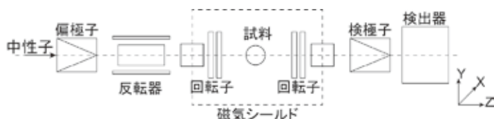
図2 J-PARC/MLFのBL10において構築した偏極パルス中性子イメージング実験体系の概要図
