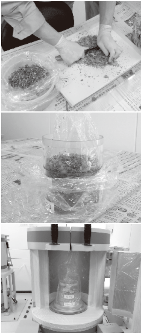
図1 モニタリングサンプルの分析 (a) サンプルを細かく刻む, (b) 容器に詰める, (c) Ge半導体検出器で測定 (福島県農業総合センターのホームページより)
