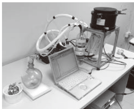
図1 開発したポータブル蛍光X線分析装置を用いた古代ガラスの分析風景（シリア、ダマスカス国立博物館にて）
