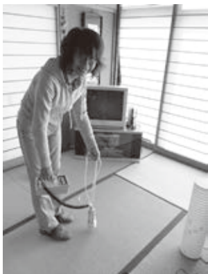
写真2 小高地区民家での表面汚染測定
