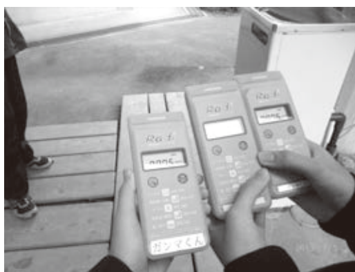
写真1 “ガンマくん”による放射線量の測定
