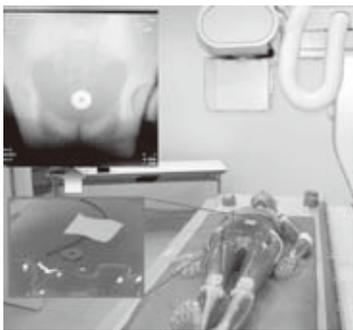
図3 SOF線量計は全体がプラスチックで構成されているため、X線透視像には全く映らない
