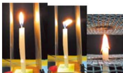
図3 左; 2枚のアルミ板の間にあるローソクの炎、中; 左側のアルミ板に4.65 kVの電圧を印加、右; 上の金属網に4.65 kVを印加
