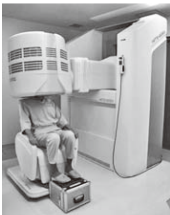
図2 体動補正機能を持つ高解像力PET装置
