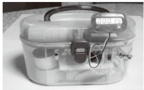
図5 携帯型の手作りGM計数器
