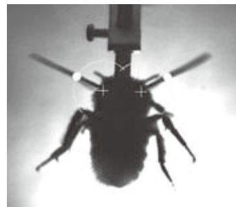
図 5 マルハナバチの羽ばたきを記録した高速ムービーの 1 コマ 白丸はソフトウェアで自動認識された羽の位置。文献 3) より
