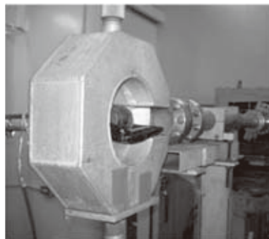
図 1 中性子発生ターゲットと軽水減速材の様子
