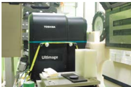
図4 測定室に設置した中性子 I.I. の様子
