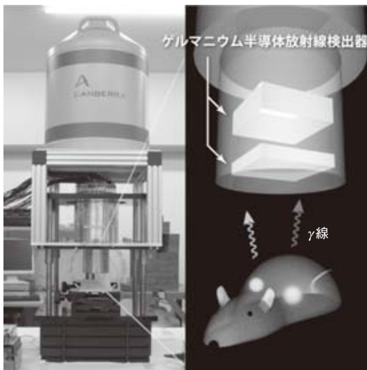
図1 半導体コンプトンカメラ“GREI” \gamma 線のエネルギーの違いから核種を識別して同時に可視化することができる。撮像性能を向上させた GREI-II を新たに構築した
