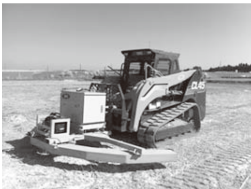
図7 PSFを用いた自走式放射線2次元分布測定システム 8) 車前方の“弓”の部分の下部にPSFが取り付けられている
