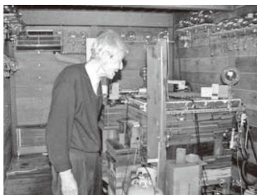
写真2 学習院大学年代測定室に設置されていた手作りの $^{14}\text{C}$ 測定装置
