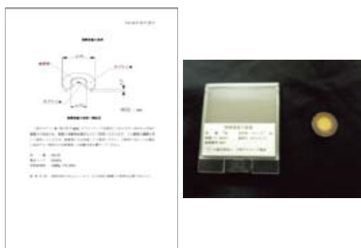
図 10 日本アイソトープ協会製薄膜陽電子線源
