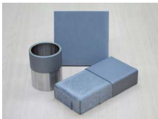
図3 放射線遮蔽・環境調和性コーティングを施工したコンクリートブロック、炭素鋼平板とステンレス円筒管
