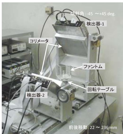
図2 心筋 SPECT システム
