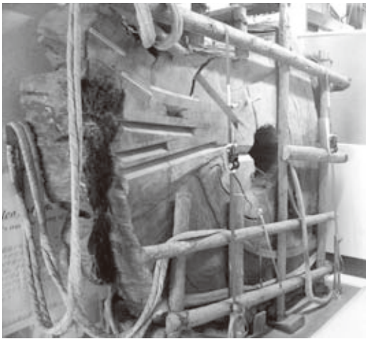
図4 測定に用いた屋久杉の円板 直径 1.9 m, 樹齢約 1,900 年。1956 年に伐採され、 1995 年に入手した。残存年輪の年代は 100~1600 年である
