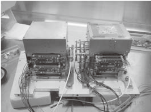
図1 製作した超広角コンプトンカメラ 2つのモジュールを左右に並べて感度を向上させている (提供: JAXA)
