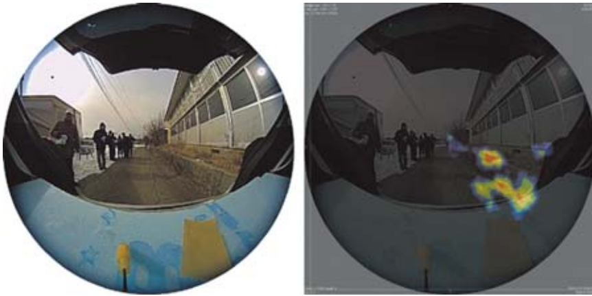
図8 飯館村で取得したイメージ (左) 魚眼レンズを装着したデジタルカメラの可視光画像。(右) 可視光画像に \gamma 線画像を重ねたもの。最大 30 \mu\text{Sv/h} のホットスポットが明るく見えている。 \gamma 線画像は 60 分積分したもの (提供: JAXA)
