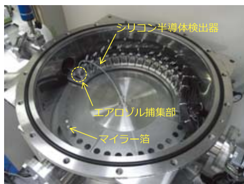
図 3 回転式連続 \alpha 線測定装置 (MANON) の写真 上部フランジを取り外した状態
