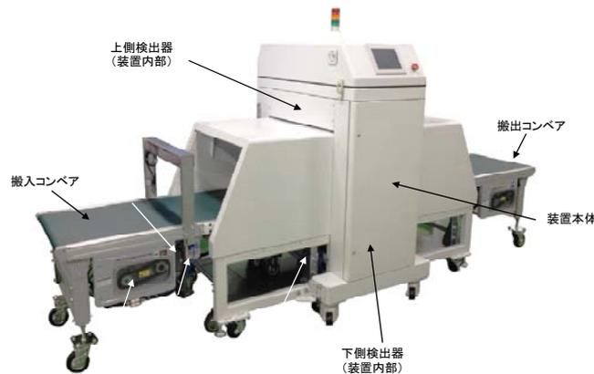
図 参 2.1 ベルトコンベア式食品モニタ構造の例
