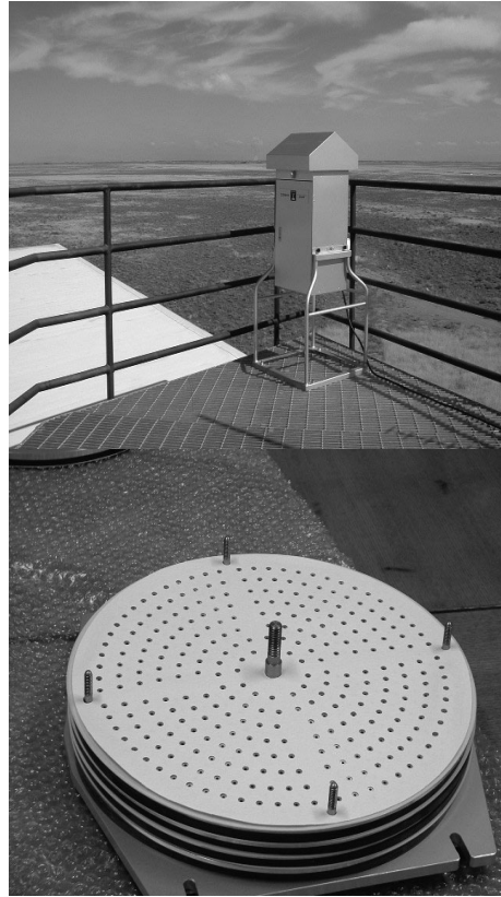
図9 米国ユタ州にある宇宙線望遠鏡施設の屋上(13 m)に設置したアンダーセンハイポリウムエアアースンプラと粒径弁別濾紙セット
