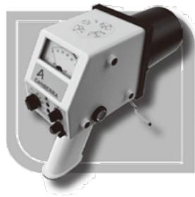
7-1\* **半導体サーベイメータ STHF-R** (超高線量γ線プローブ) 別途問合せ 1~3ヵ月
