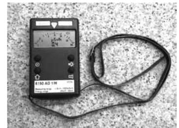
7-1\* **エネルギー補償シンチレーションサーベイメータ TCS-171B 61万円 1ヵ月**
