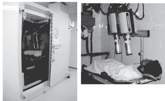
写真2 精密型全身カウンタの例。 (左：鉄遮蔽室外からの撮影，右：鉄遮蔽室内での撮影)
