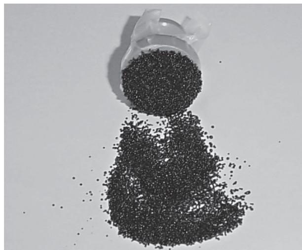
図2 磁石にくっつく磁性イオン交換樹脂
