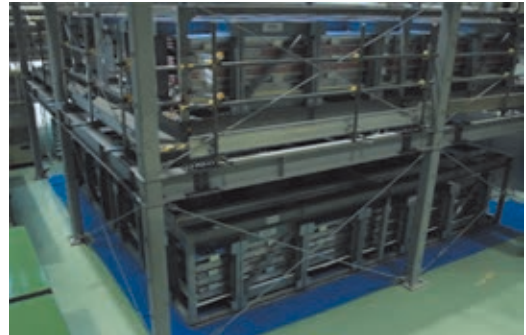
図4 東芝生産技術センターで組み立てたミュオン軌跡検出器
