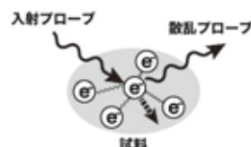
図1 非弹性散乱における電子励起
