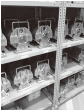
写真6 照射条件ごとのレンジモジュレーションフォイル一式 (左) 及び陽子線照射ライン上に設置されたレンジモジュレーションフォイル (右)
