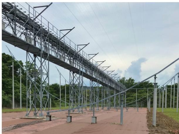
図3 焦点に並ぶダイポールアンテナと反射面
